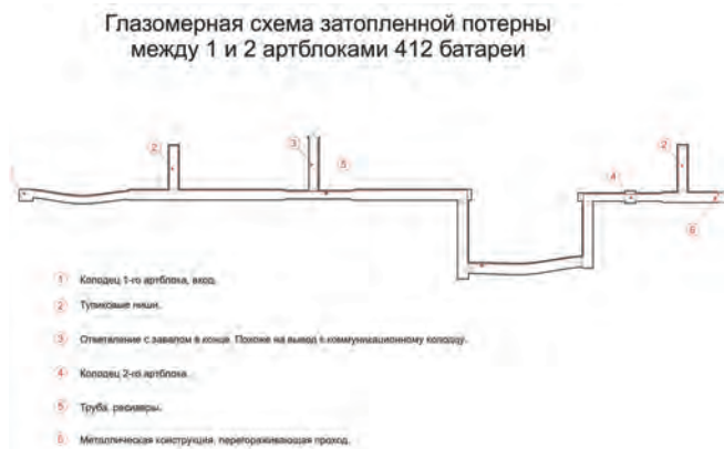
Фото 12. План-схема участка потерны между 1 и 2 артблоками 412 батареи
