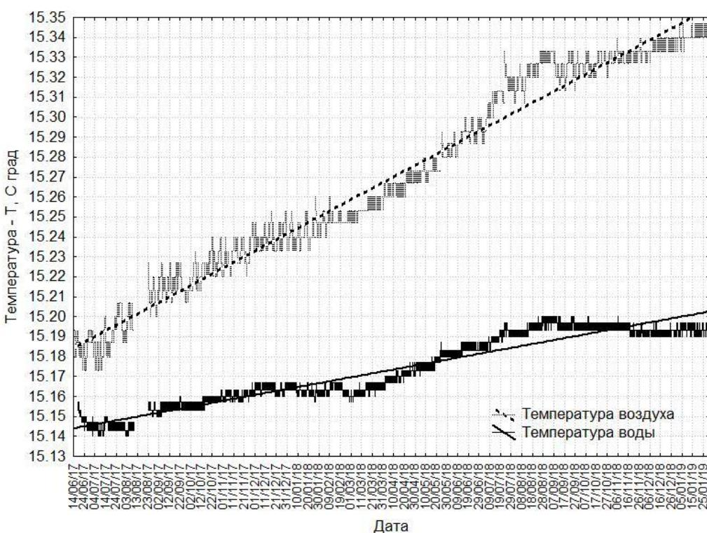
Рис. 1. Графики изменений температур ( $T$ ,  $^{\circ}\text{C}$ ) воздуха в catacombah и воды в скважине за период наблюдений 14.06.2017 – 30.01.2019 гг. Прямыми линиями показан линейный тренд.
